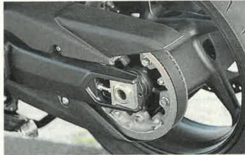
Ebenfalls eine fette Alu-Schwinge. Das über ein Hebelsystem angelenkte Federbein liegt unsichtbar unter dem Motor
