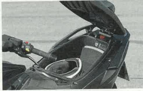
Wie beim Yamaha öffnet das beleuchtete und mit Filz ausgeschlagene Helmloch nach hinten. Es fasst einen Integral- und einen Jethelm
