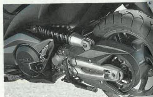
Massive Alu-Schwinge mit direkt angelenktem, nicht verstellbarem Federbein. Der Riemen baut deutlich breiter als beim TMax
